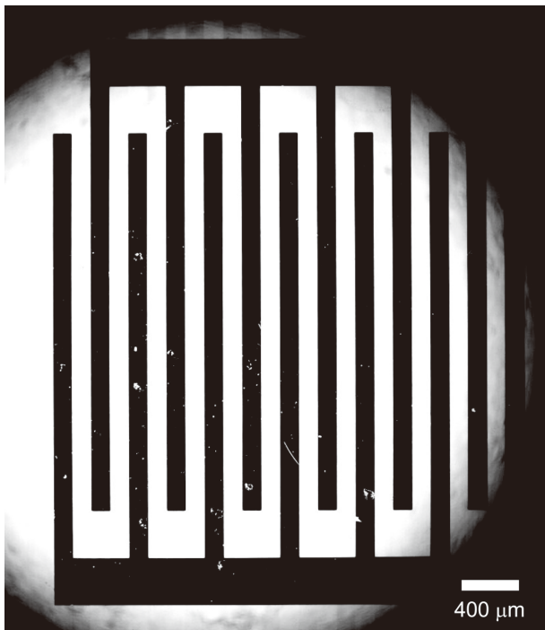
図 4 作成した IDT 電極の顕微鏡写真。
